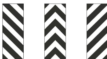
2.2. Vertikalios juodos ir baltos juostos žymi tiltų, viadukų, tunelių konstrukcijų apatinį kraštą.
